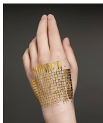
皮膚貼り付け型 ナノメッシュセンサー【2】 (東京大学) 密着性の高い有機デバイスにより、あらゆる部位からの微細な電気信号を低ノイズで測定できる。
