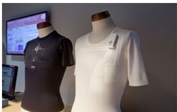
ウェアラブルセンサー【1】 (hitoe, NTTデータG) 着ることで体温や心拍数等の生体情報の取得が可能。
