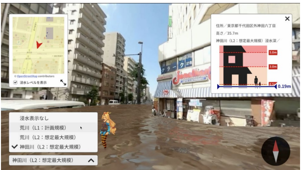
FLOODEAU【17】 360°歩行映像のPLATEAUへの動的なプロジェクションと洪水可視化。防災シミュレーションが可能。（東京大学、国土交通省）
