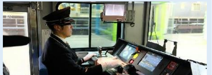
出典：JR東日本（自動列車運転装置の走行試験）
