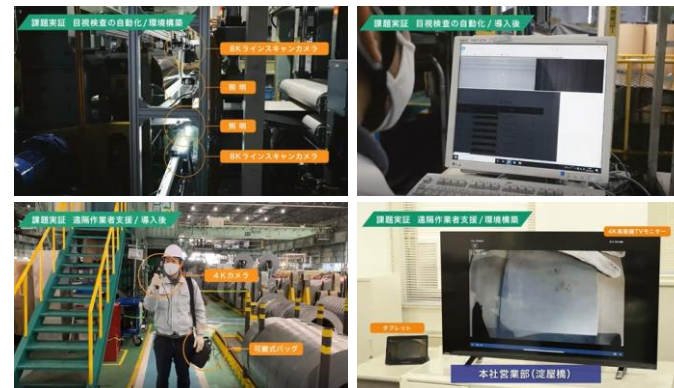
8Kカメラで取得した高精細映像を伝送。AIにより設備の傷の有無などを判定。リアルでの臨場と同レベルで遠隔での品質を確認
